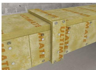
6.6 att. Izolācijas plākšņu savienojumu izkārtojums, principiālā shēma
