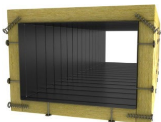
6.1 att. Izolācijas lokšņu uztādīšana horizontālajam kanālam
